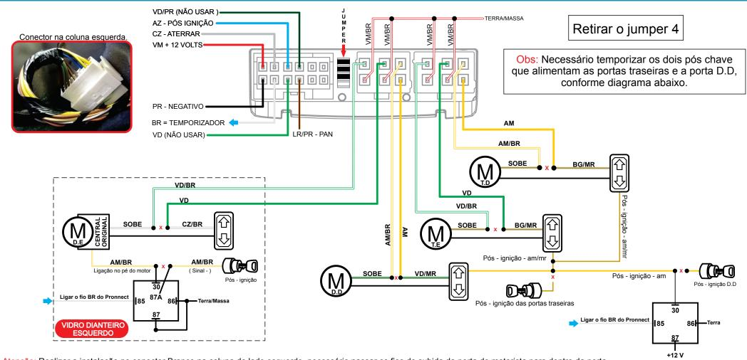
Atenção: Realizar a instalação no conector Branco na coluna do lado esquerdo, necessário passar os fios de subida da porta do motorista para dentro da porta.
