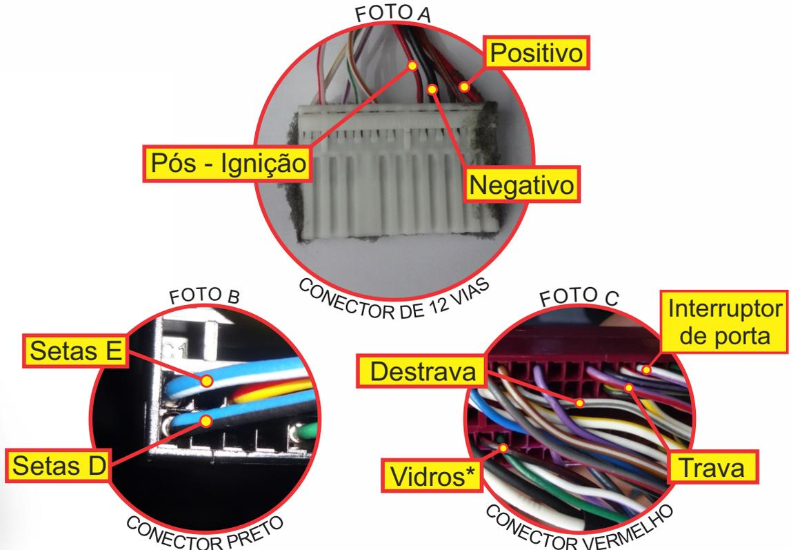
Conecte o fio **vermelho do alarme (+12V)** ao fio vermelho do conector original branco de 12 vias, localizado na coluna do lado esquerdo, atrás do tapete. Conforme foto **A** acima.
