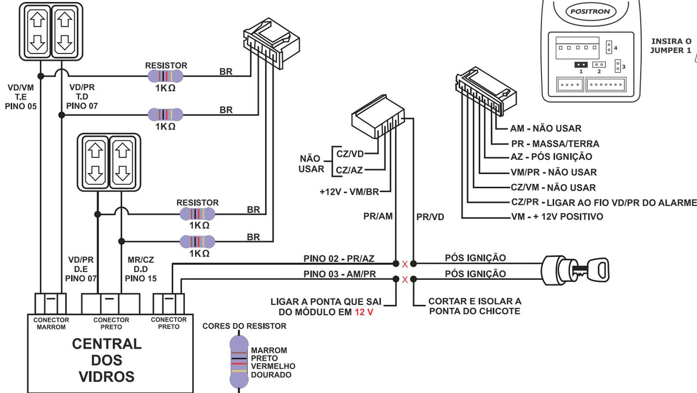
**Observação:** Ao efetuar o esquema acima, o sistema de travamento original por velocidade, não irá mais funcionar e passará a funcionar através do travamento automático do alarme.
