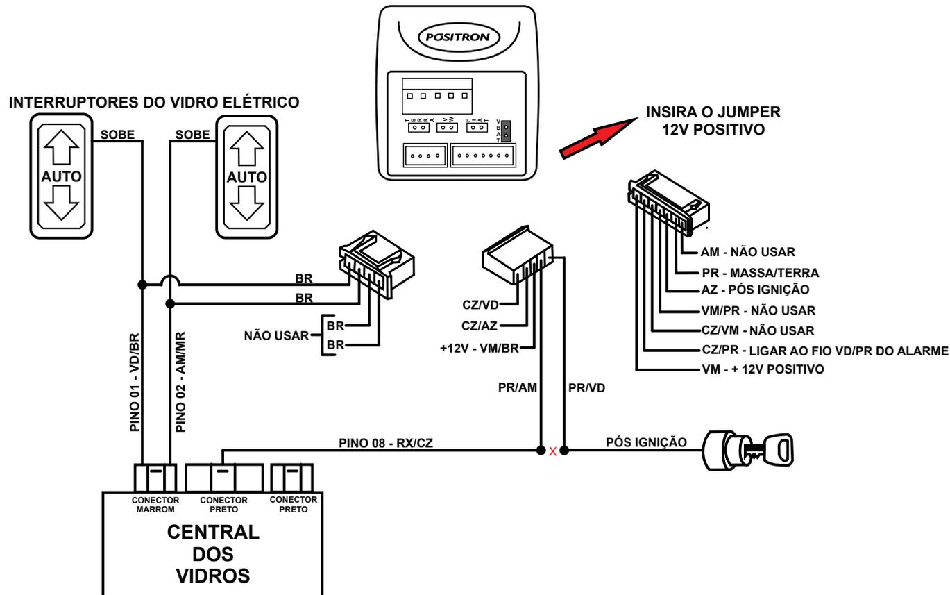
**Atenção:** Módulo original localizado na coluna esquerda, realizar instalação conforme diagrama acima.
