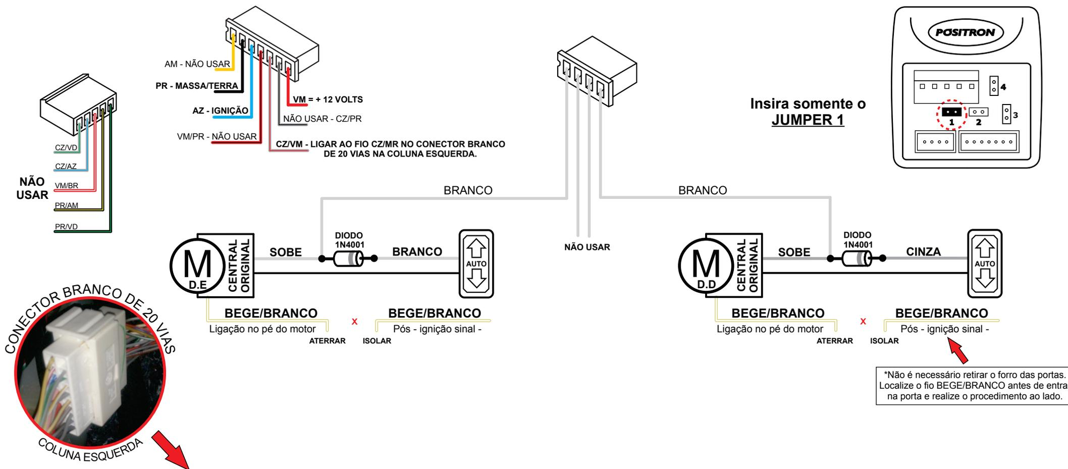
**ATENÇÃO:** Pegar os fios de subida das portas DD. no conector de 20 vias, e da porta DE direto no botão da porta do motorista. **Necessário colocar o diodo conforme diagrama acima.**
