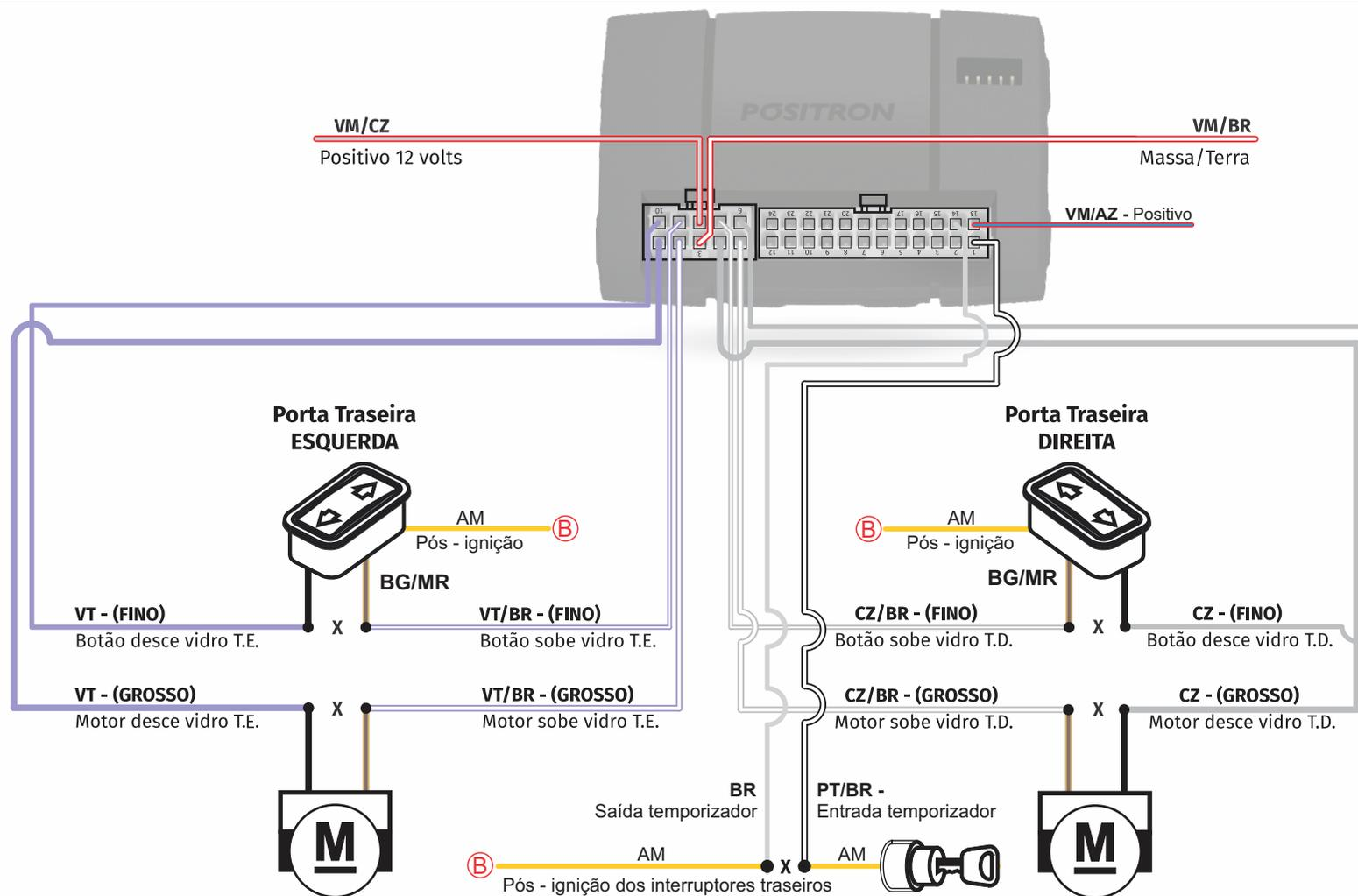
**(B)** Localizar o fio AM direto nos interruptores, ou na caixa de fusíveis (fusível de 20Amp), localizado acima do puxador do capô.
