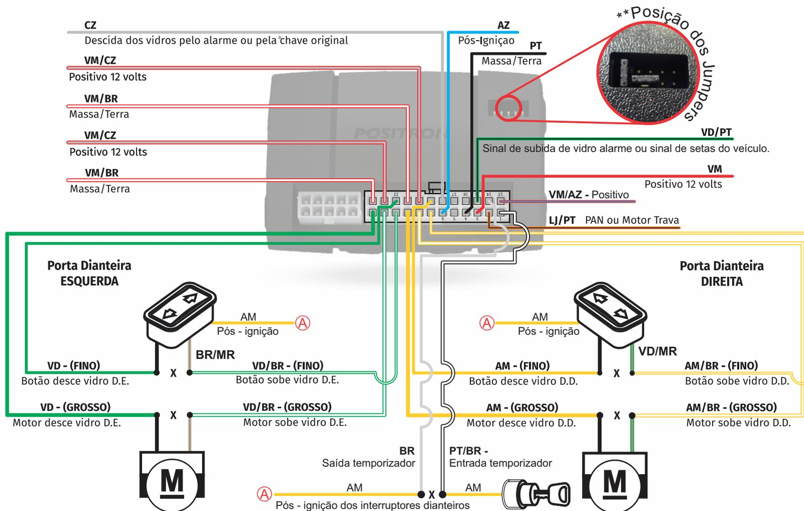
(A) Localizar o fio AM direto nos interruptores, ou na caixa de fusíveis (fusível de 20Amp), localizado acima do puxador do capô.
