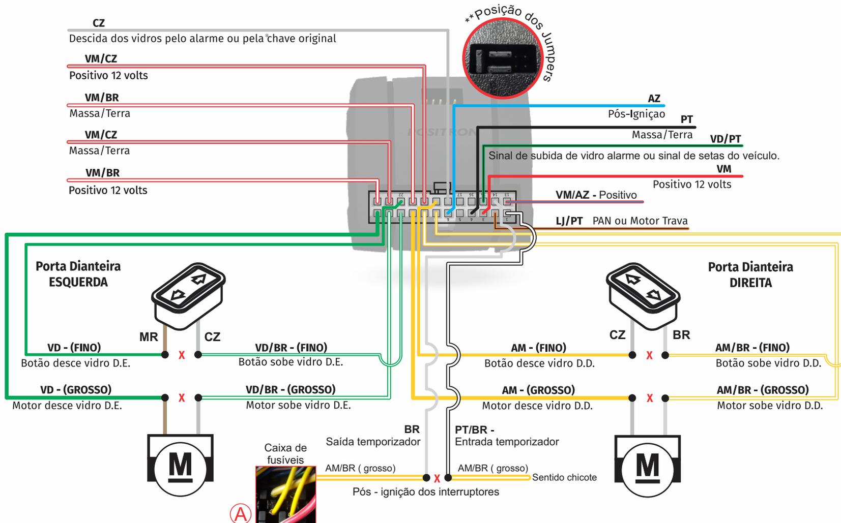
**(A)** Para o funcionamento adequado do Pronnect 280AE é necessário temporizar os interruptores. Localize a caixa de fusíveis abaixo do volante, retire a tampa plástica de acabamento, encontre dois fusíveis de 25 Amperes, vire a caixa de fusível para encontrar o fio AM/BR grosso. Realize a instalação como informado neste informativo
