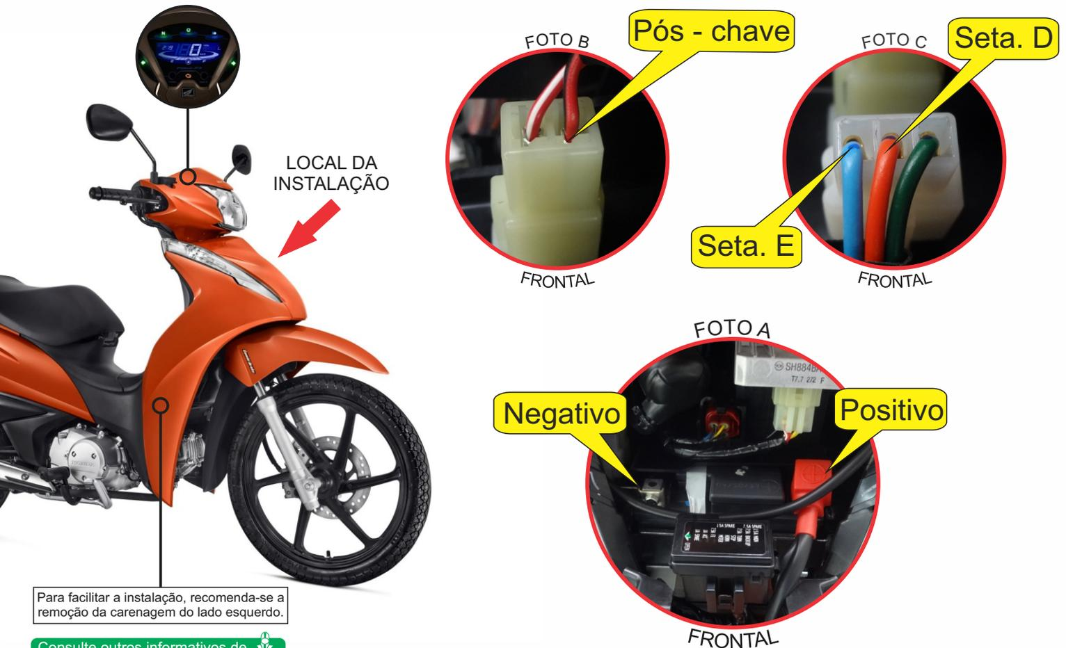
Para facilitar a instalação, recomenda-se a remoção da carenagem do lado esquerdo.
