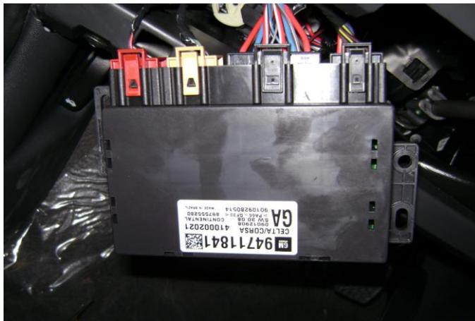
Conecte o fio **Vermelho do alarme (+ 12v)** ao fio Vermelho, pino 23 do conector Preto de 23 vias, localizado no módulo do alarme original, conforme foto.
