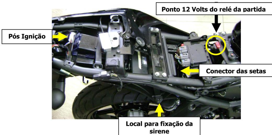
Para efetuar a ligação do fio **Vermelho do alarme (+12V)**, localize o borne positivo do relé da partida elétrica. Conforme foto.
