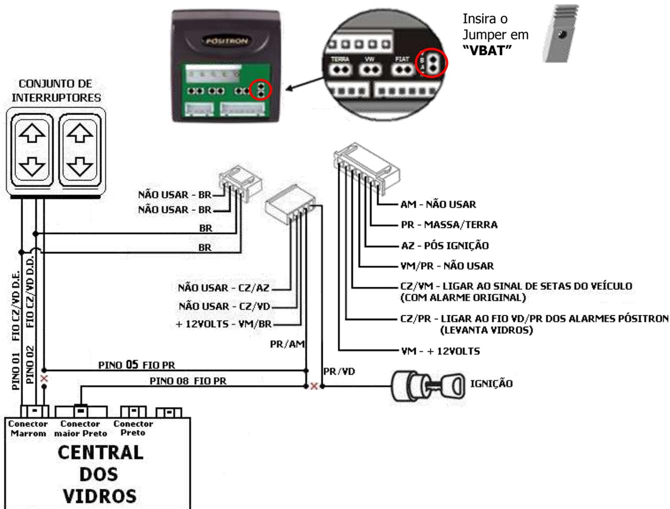
**Atenção!** Será necessário desmontar o módulo original abaixo do acabamento plástico da coluna esquerda e localizar os fios e pinos, conforme esquema acima.
