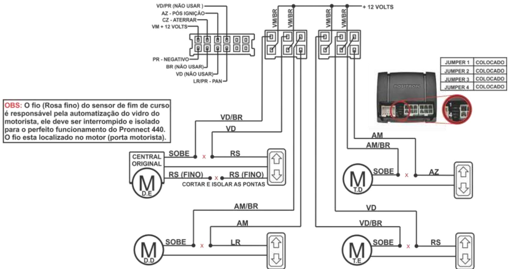
**Atenção:** Devido as características originais do veículo, quando o botão do bloqueio dos vidros traseiros for pressionado os vidros traseiros podem ser acionados.
