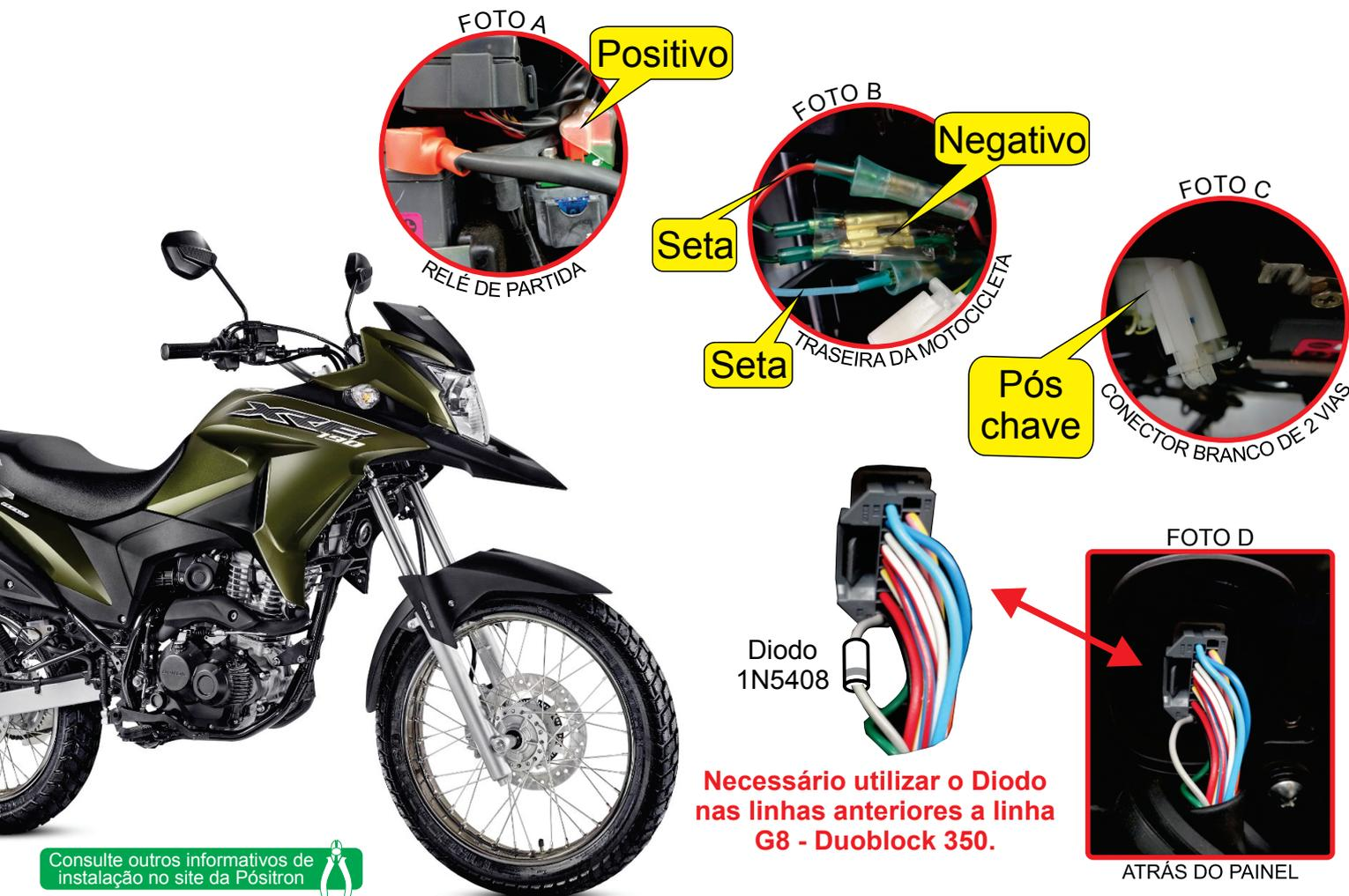
**IMPORTANTE:** É necessário a instalação de um diodo 1N5408 no circuito de setas, pois este modelo de motocicleta aciona a bomba elétrica/painel quando as setas estiverem piscando através do alarme (caso a chave de seta esteja acionada). Localize o fio Cinza no pino 10 do conector cinza de 20 vias atrás do painel da motocicleta, conforme foto D acima.
