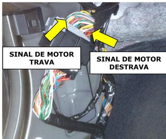
**Conector localizado na coluna esquerda**
