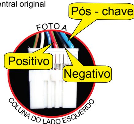
Conecte o fio vermelho do alarme (**+12V**) ao fio vermelho/verde no chicote do alarme original (conector branco de 06 vias), na coluna do lado esquerdo. Conforme foto **A** acima.
