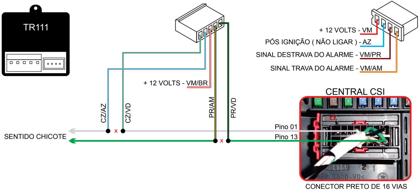
**AUTOMATIZAÇÃO DOS VIDROS COM A PORTA DO MOTORISTA INTELIGENTE:** Será necessário instalar um Pronnect 440, localizando os fios de subida no chicote atrás dos interruptores do conjunto do motorista, conforme diagrama abaixo.
