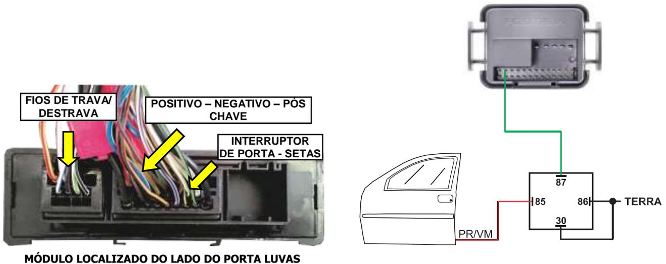
Conecte o fio vermelho do alarme (**+12v**) ao fio laranja/branco pino 17 do conector preto de 23 vias localizado do lado direito do porta luvas, conforme foto acima.
