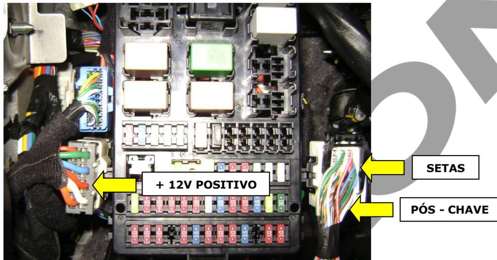
Conecte o fio **Vermelho do alarme (+ 12v)** ao fio Vermelho do conector de 8 vias Cinza na caixa de fusíveis.
