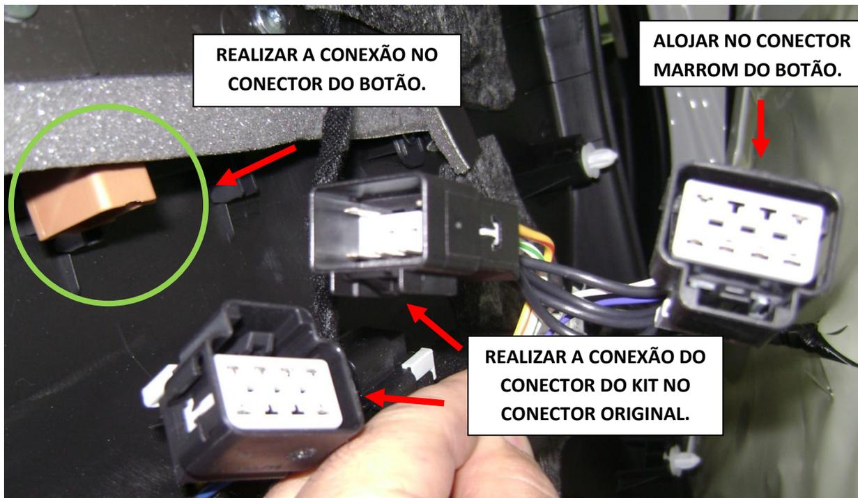
**REALIZAR A CONEXÃO NO CONECTOR DO BOTÃO.**
