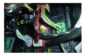
Conecte o fio Vermelho do alarme (+12v) ao terminal 01 do conector Azul de 3 vias, localizado abaixo da coluna da direção.
