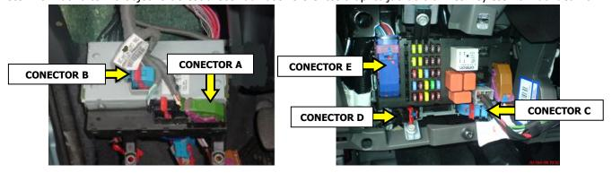
Conecte o fio **Vermelho do alarme (+ 12v)**, ao fio Vermelho/Verde pino 07 do conector A de 20 vias (Verde), localizado na parte traseira da caixa de fusíveis.
