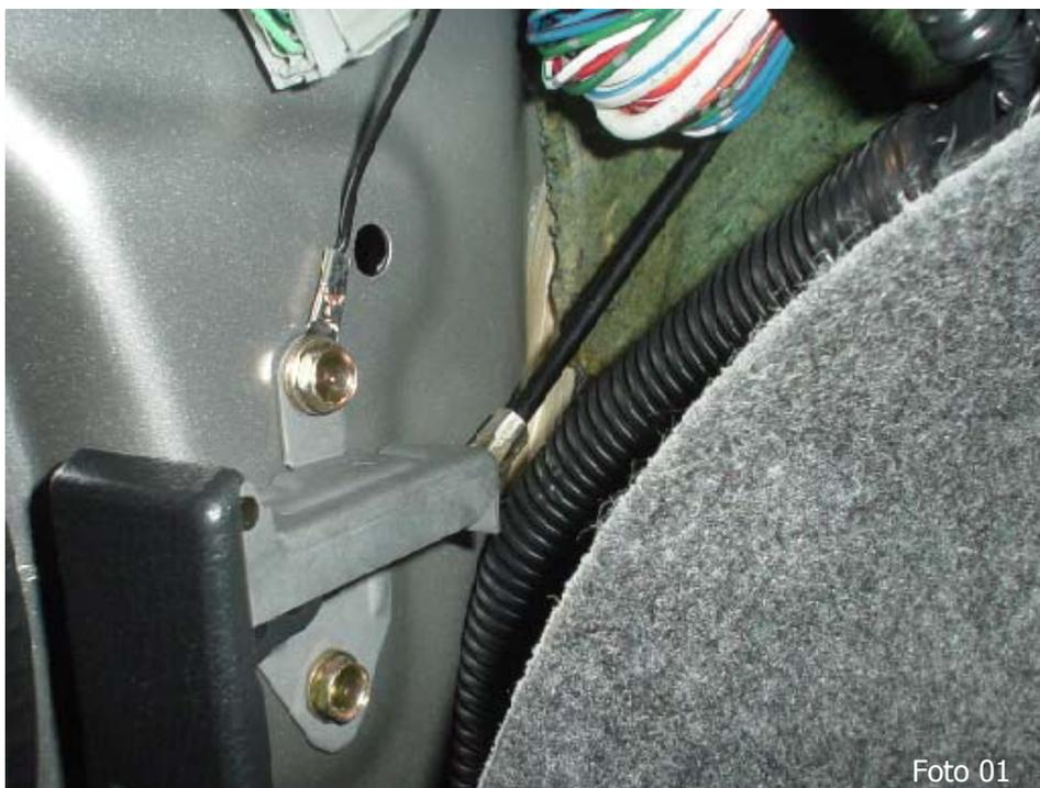
O fio massa/terra do alarme deve ser ligado diretamente ao chassi do veículo, no parafuso localizado abaixo do puxador de capô, conforme indicado na foto 01.
