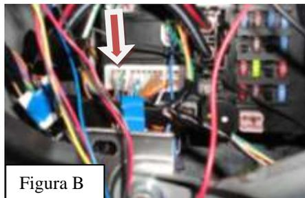
Conecte o fio **Verde** do alarme (**Interruptor de porta**), ao fio Amarelo, localizado no chicote da coluna esquerda.
