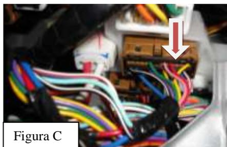
Conecte o fio **Amarelo** do alarme (**sinal de motor "trava"**), ao fio VERMELHO localizado na caixa de fusíveis conector marron.
