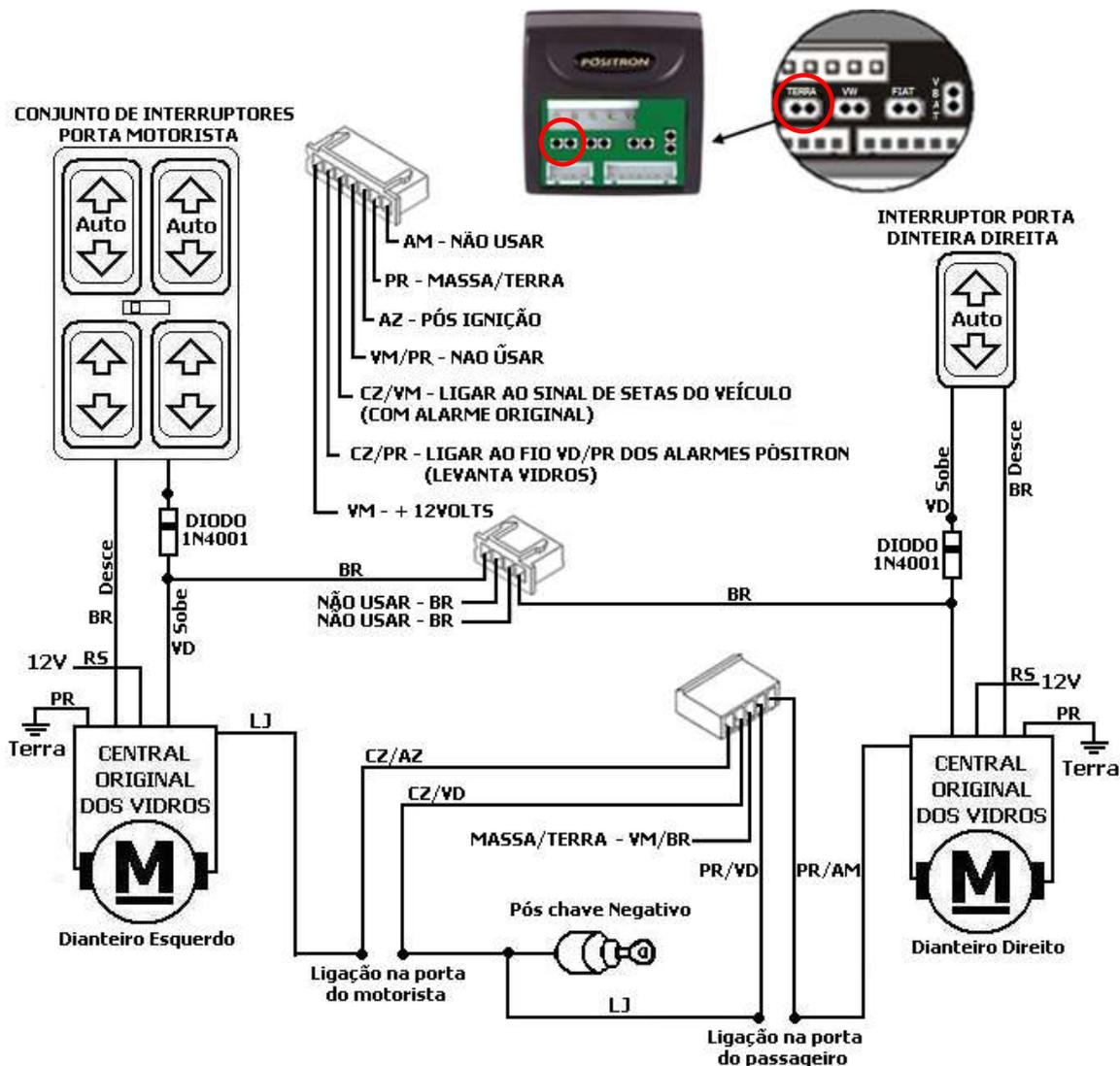
**Observação:** Para a ligação dos fios brancos, identifique o pós ignição, que trabalha com sinal **Negativo**, localize o fio de cor Laranja no pé dos motores dianteiros, conforme esquema acima. Para as demais portas instalar uma SW430, localizando os fios de motores dentro de cada porta, não sendo necessário o uso de relés.
