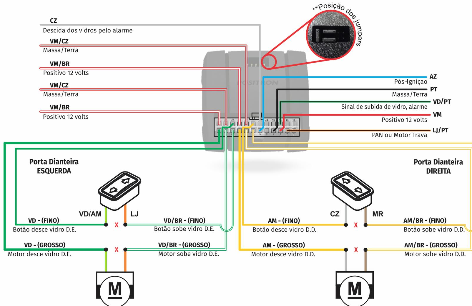
**Aviso:** Após concluir a instalação e for ligar a ignição pela primeira vez, aguarde três segundos antes de pressionar qualquer interruptor, pois o módulo precisa deste tempo para ler as informações do interruptor/motor do vidro. Este processo facilitará a programação dos vidros.
