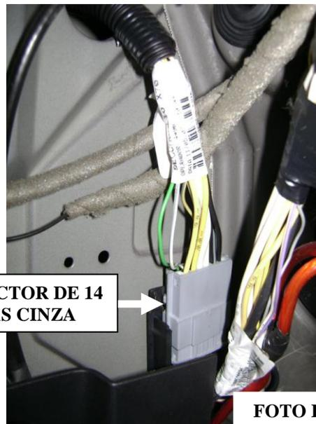
Conecte o fio **Vermelho do alarme (+ 12 Volts)** ao fio Vermelho do conector de 14 vias Preto na chave de setas, conforme foto A.
