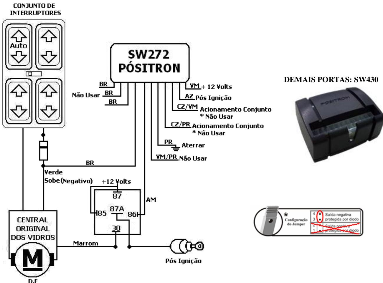
**Obs:** A informação acima, só servirá se o veículo tiver módulo no pé do motor na porta esquerda, contendo 5 fios. Localize os fios das demais portas D.D, T.E e T.D na saída do chicote na coluna esquerda.
