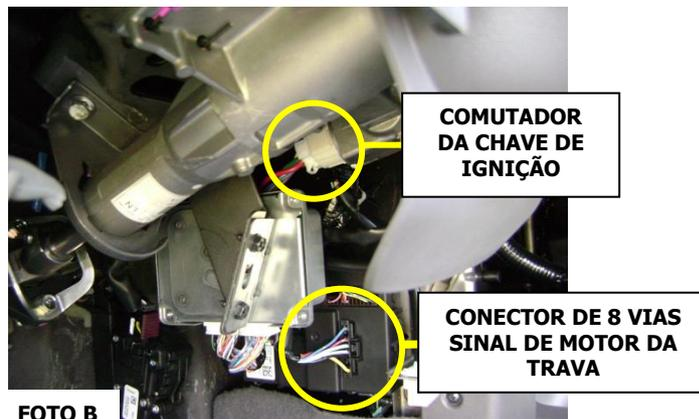
Conecte o fio **Vermelho do alarme (12 v)** ao fio Verde do conector de 6 vias Branco no comutador da chave de ignição. Conforme Foto B
