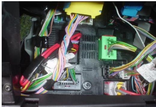
**ACIONAMENTO DAS TRAVAS ELÉTRICAS:** Localize o conector Cinza de 16 vias, Terminal 13 e 15 na central CSI. Para efetuar a ligação da TR111 interrompa os fios de motor, conforme esquema abaixo.
