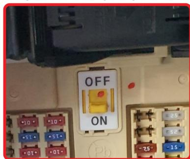
Para que as travas elétricas funcionem corretamente através dos alarmes Pósitron, é necessário que a chave esteja na posição On, conforme imagem acima.
